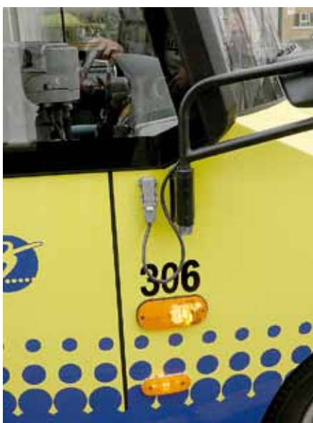
Nicht optimal gelöst ist das offenliegende Kabel außen an der Bordwand.
