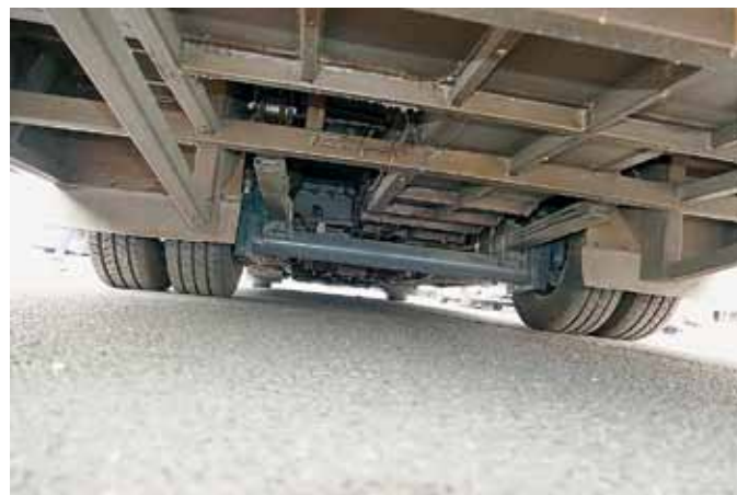
Die zwillingsbereifte, blattgefederte Hinterachse stammt vom Mercedes-Benz Sprinter.
