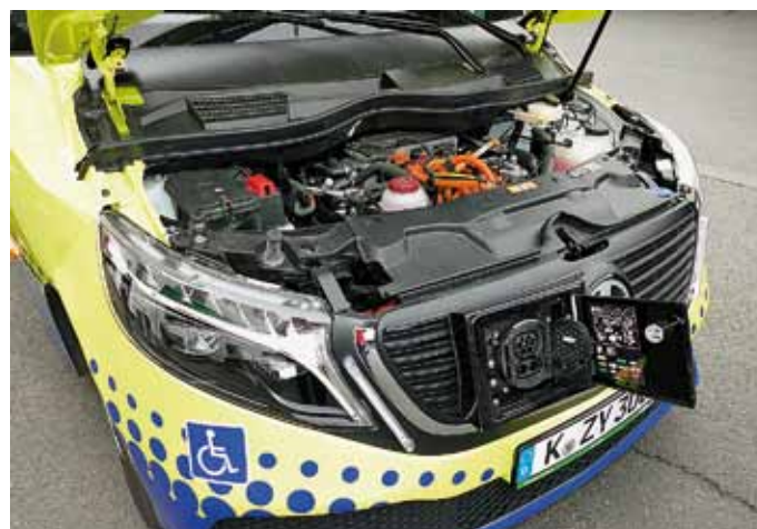
Die Technik des E-Vito befindet sich vorne unter der Haube. Vor den Frontgrill wurde die Ladesteckdose montiert.
